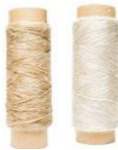
Slika 4. Visokoorijentirana lanena roving pređa male uvojitosti ili bez uvoja[23]
