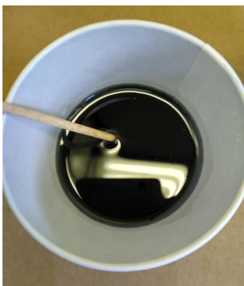
Slika 13. Priprema matrice u papirnoj čaši
