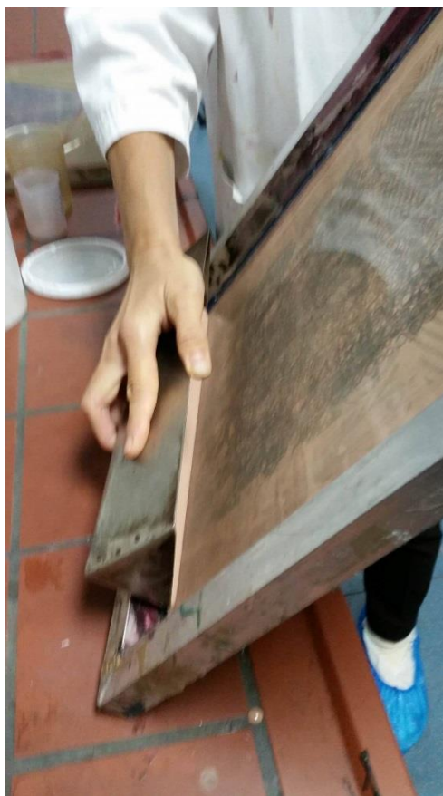
Slika 46: Nanošenje fotoemulzije na sito
