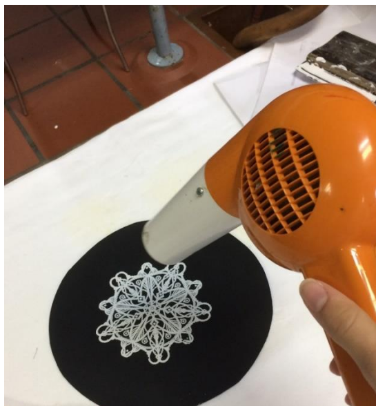
Slika 38: Sušenje motiva nakon tiska
