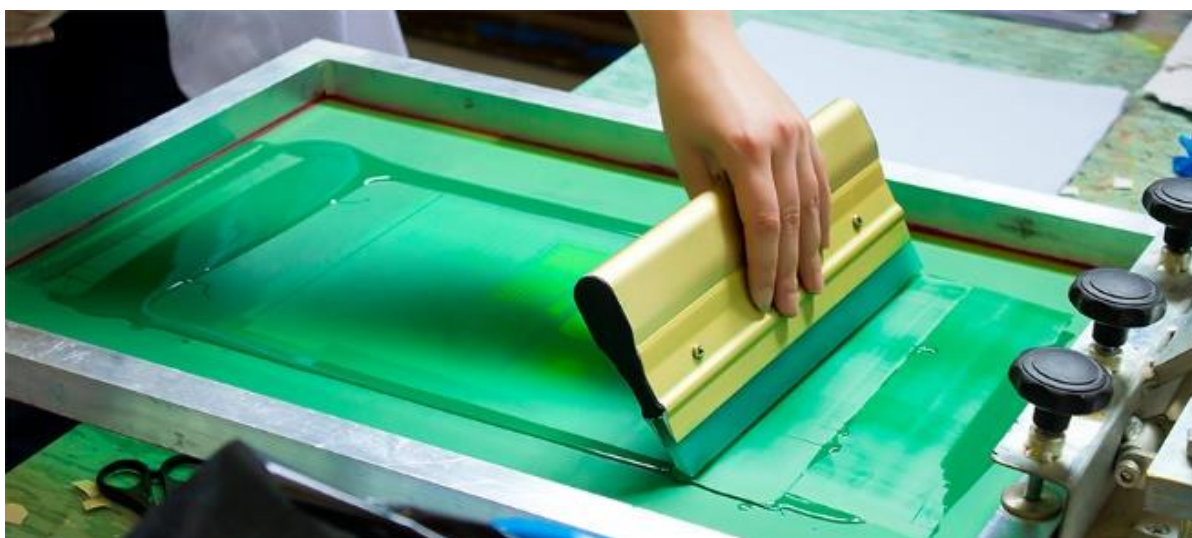
Slika 7: Prikaz protiskivanja tiskarske paste [13]
