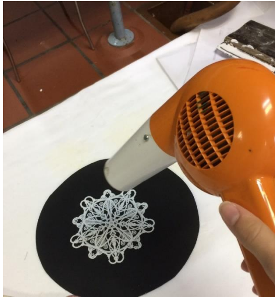
Slika 38: Sušenje motiva nakon tiska
