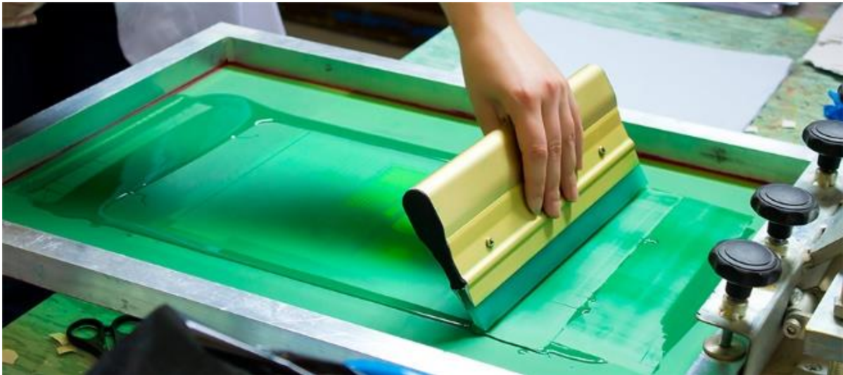
Slika 7: Prikaz protiskivanja tiskarske paste [13]
