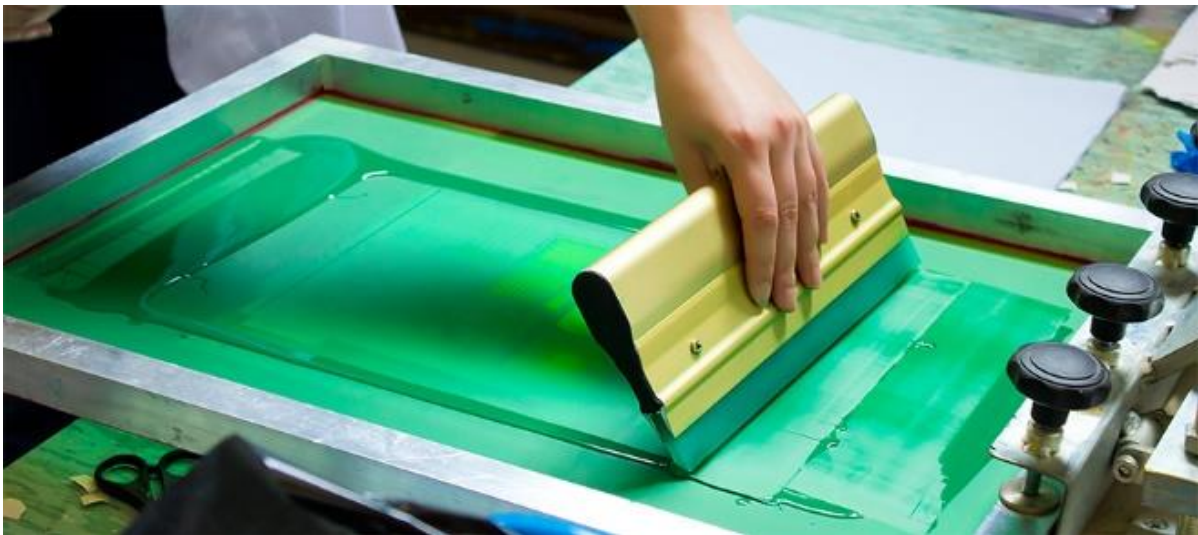
Slika 7: Prikaz protiskivanja tiskarske paste [13]
