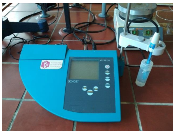
Sl. 12 pH – metar sa pripadajućom elektrodom
