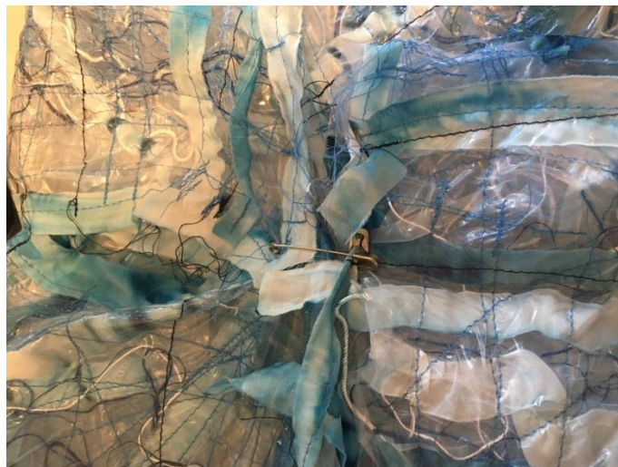
Slika 16. Spajanje manjih komada prošivene folije
