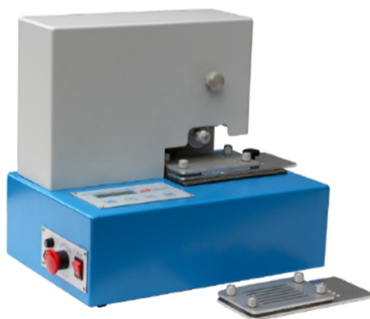
Slika 28. Prikaz uređaja za ispitivanje presijecanja zaštitnih rukavica [12]
