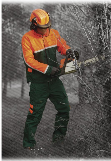
Slika 14. Hlače i jakna od materijala otpornog na rezanje motornom pilom [8]
