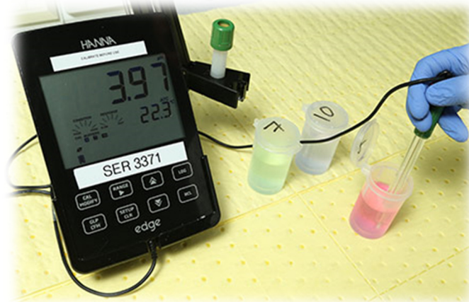
Slika 26. Prikaz ispitne metode određivanja pH vrijednosti materijala od kojih su izrađene zaštitne rukavice [19]
