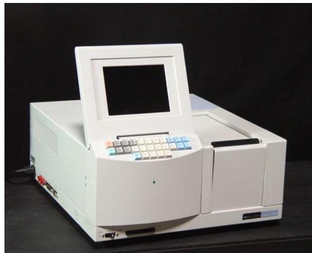
**SI.3.3.5.1.** UV/Vis spektrofotometar, Perkin Elmer Lambda EZ 201 [40].
