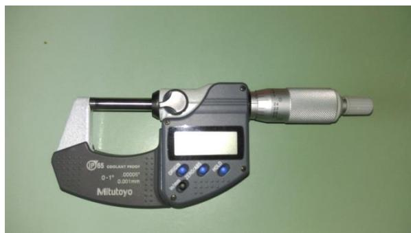
Sl. 3.3.2.1. Debljinomjer – mikrometar.
