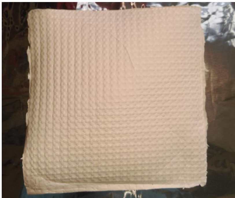
Sl. 3.2.4.2. Elektrospredeni materijal s topografijom 3D printanog kolektora 1.
