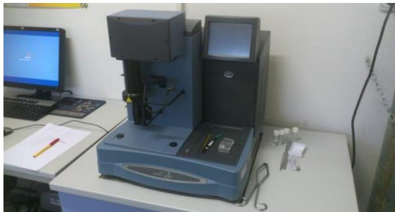
**Sl. 3.3.3.1. TGA analizator Q500, TA Instruments.**
