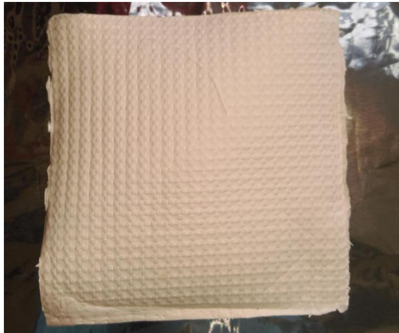
**Sl. 3.2.4.2.** Elektroispredeni materijal s topografijom 3D printanog kolektora 1.
