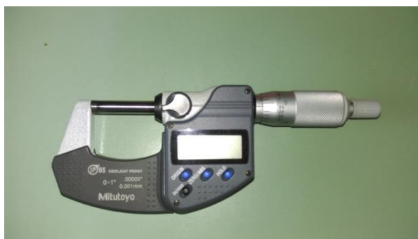
Sl. 3.3.2.1. Debljinomjer – mikrometar.
