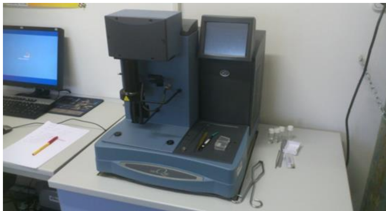
SI. 3.3.3.1. TGA analizator Q500, TA Instruments.
