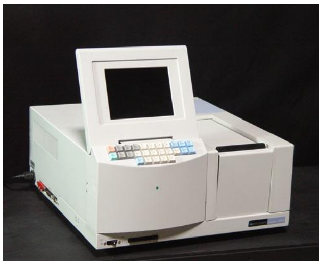
SI.3.3.5.1. UV/Vis spektrofotometar, Perkin Elmer Lambda EZ 201 [40].
