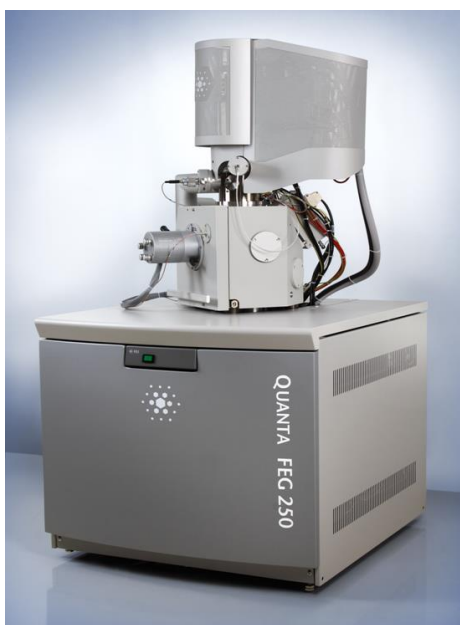
Sl. 3.3.1.1. SEM mikroskop QUANTA 250, FEI [38].
