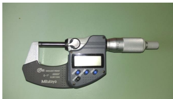
Sl. 3.3.2.1. Debljinomjer – mikrometar.
