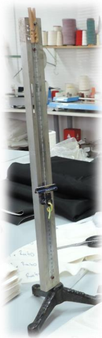
Sl. 15. Postupak određivanja utroška niti u tkanini (utkanja)
