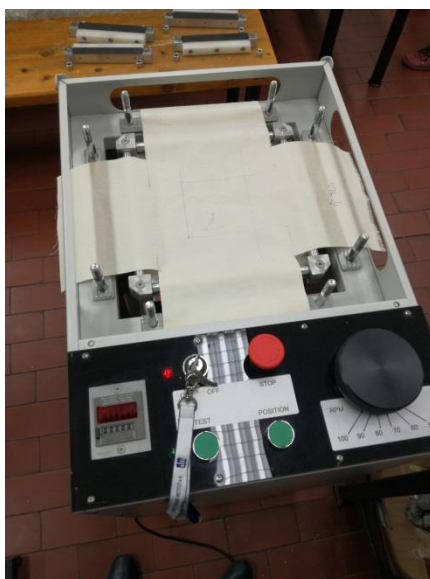
SI. 18. Uređaj za dvoosno cikličko naprezanje tkanina
