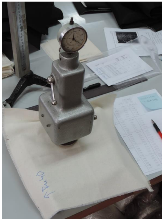
SI. 16. Debljinomjer za plošne proizvode
