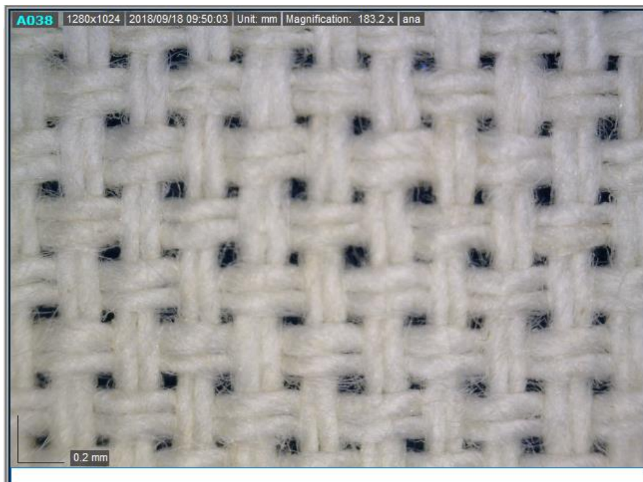
SI. 13. Projekcija uvećanog veza tkanine uz pomoć Dino lite mikroskopa
