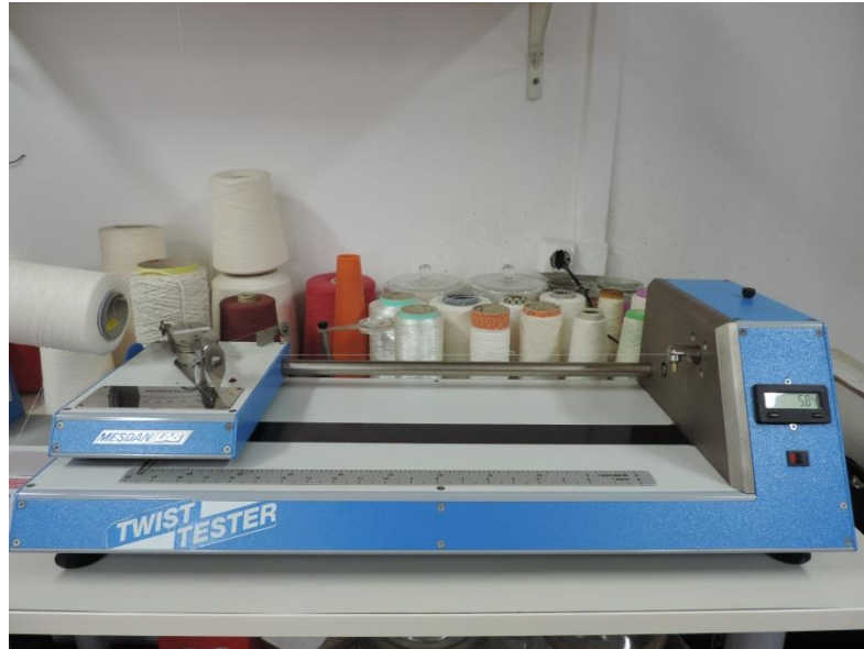
SI. 11. Torziometar Twist Tester za određivanje uvojitosti pređe
