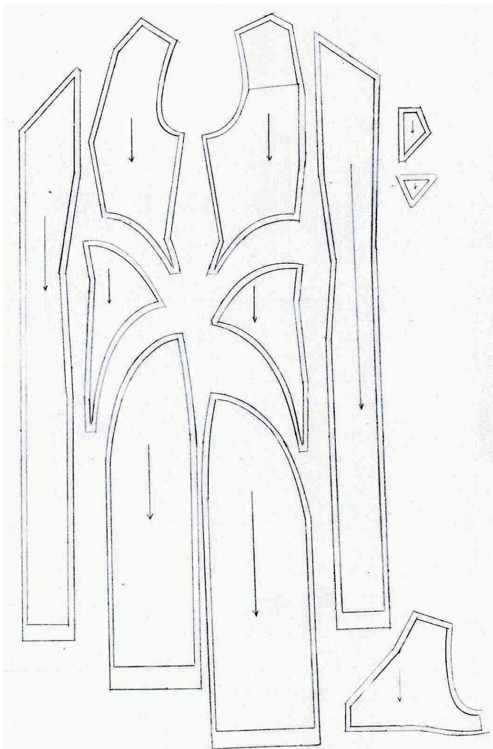
Slika 52: Prikaz krojnih dijelova i šavnih dodataka modela haljine za ženski tip tijela “obrnuti trokut“
