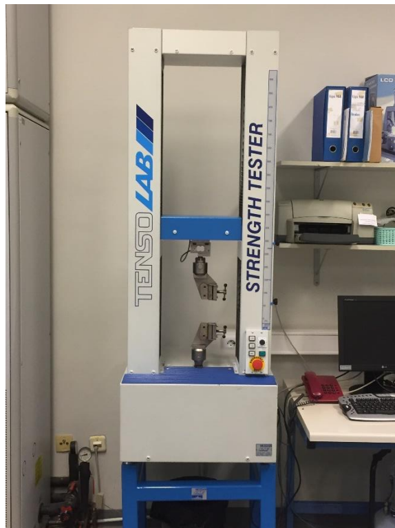
Sl.7. Univerzalni dinamometar TensoLab 3000, Mesdan
