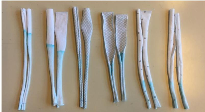
Sl. 15. Uzorci nakon ispitivanja vertikalnim testom
