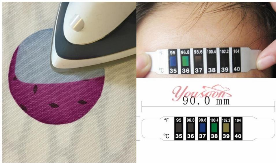
Sl.19. Primjer termosenzitivnog otiska i fleksibilne folije za očitanje temperature
