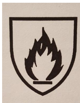
Slika 1. Simbol za zaštitu od topline i plamena prema standardu ISO 13688 [4]
