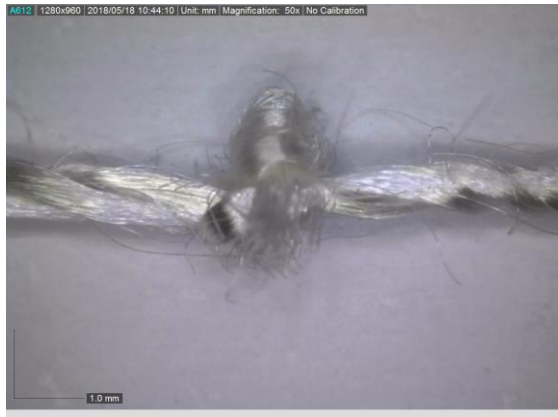
Slika 54. Fotografija konfiguracije U3 nakon procesa habanja
