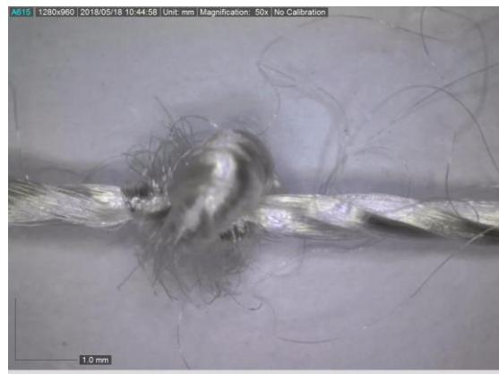
Slika 56. Fotografija konfiguracije U5 nakon procesa habanja
