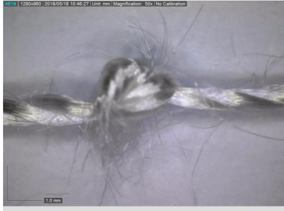
Slika 60. Fotografija konfiguracije U9 nakon procesa habanja
