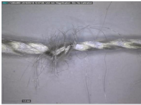
Slika 62. Fotografija konfiguracije U11 nakon procesa habanja
