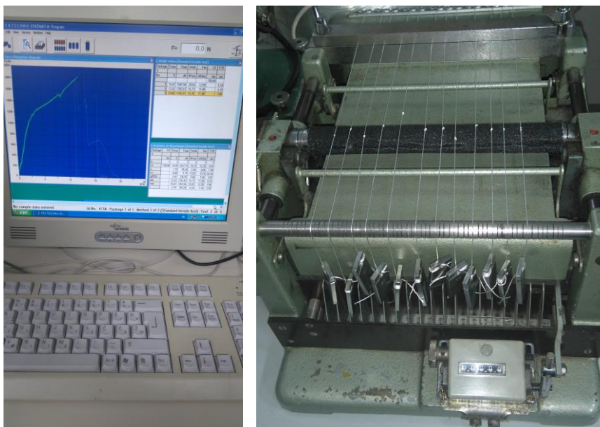
Slika 3. Prikaz zaslona monitora prilikom rada dinamometra (lijevo) i prikaz habalice Zweigle prilikom rada (desno)
