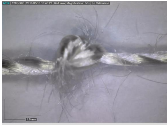
Slika 60. Fotografija konfiguracije U9 nakon procesa habanja
