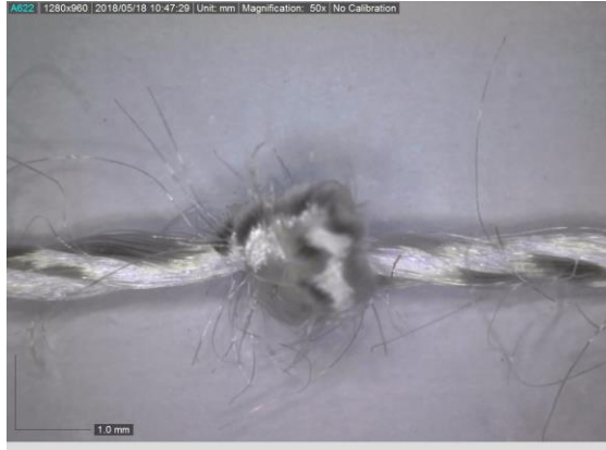
Slika 63. Fotografija konfiguracije U12 nakon procesa habanja
