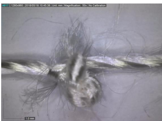
Slika 58. Fotografija konfiguracije U7 nakon procesa habanja
