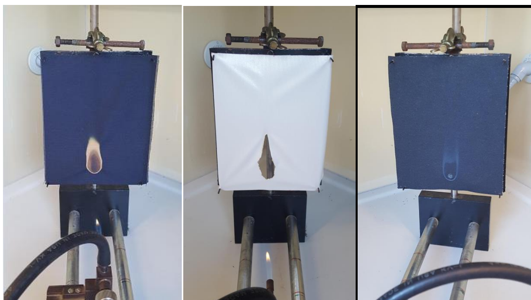
Sl. 25 Prikaz uzoraka nakon provedbe testa gorenja u trajanju od 10 s
