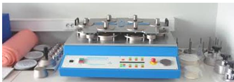
Slika 17. Habalica prema Martindale-u primijenjena za ispitivanje otpornosti na habanje i sklonosti nastanka površinskog pilinga pletiva [25]
