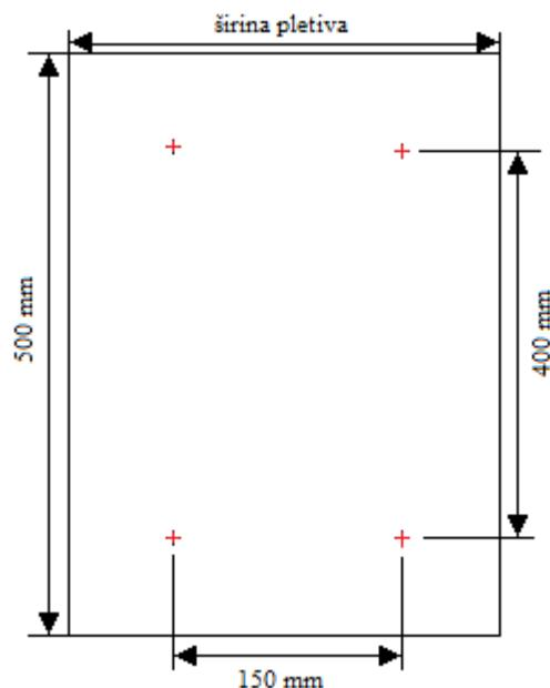
Slika 23. Shematski prikaz označivanja epruveta za dimenzijsku stabilnost kod cjevastih pletiva
