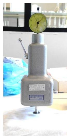
Slika 15. Debljinomjer primjenjen za utvrđivanje debljine uzorka
