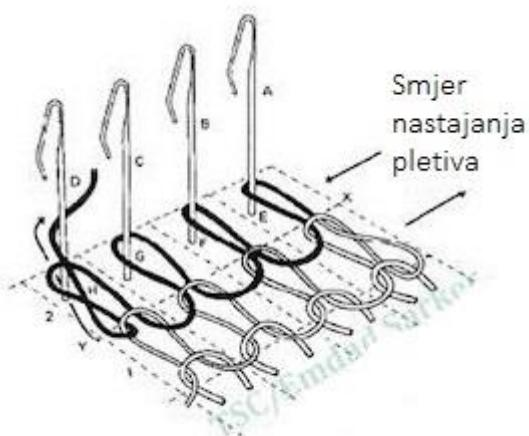
Slika 2. Shematski prikaz izrade kulirnih pletiva [5]
