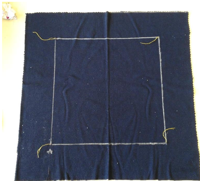
Slika 24. Shematski (a) i stvarni (b) prikaz označivanja epruveta za ispitivanje spiralnosti metodom A
