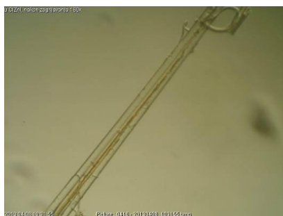
Vlakna zagrijana u ClZnI-reagensu (školski mikroskop, 160x)
