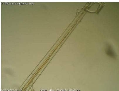
Vlakna zagrijana u ClZnI-reagensu (školski mikroskop, 160x)
