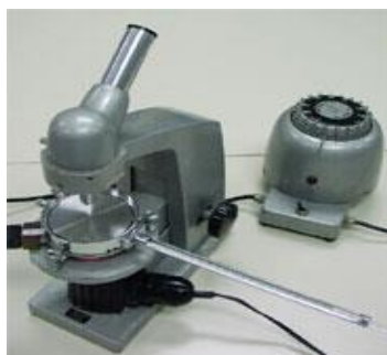
Slika 14 Mikroskop za određivanje tališta Reichert
