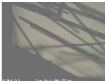
Mikroskopsko određivanje točke taljenja (16x)
