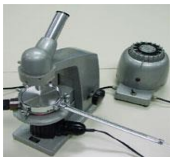
Slika 14 Mikroskop za određivanje tališta Reichert
