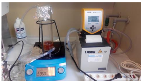
Slika 16 Aparatura za pripravu sol gel-prevlaka (Zavod za materijale, vlakna i ispitivanje tekstila)
