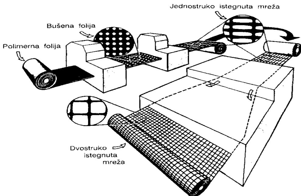
Slika 4 Shematski prikaz postupka proizvodnje mreža sustava Tensar [6]
