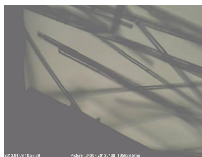
Mikroskopsko određivanje točke taljenja (16x)
