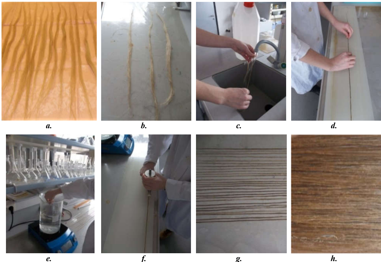
Slika 18. Priprava viskooorijentirane pređe iz duljih vlakana predivog lana: a. snopići vlakana, b. snop vlakana raspoređen na dvostruku duljinu, c. močenje snopa vlakana u hladnoj vodi, d. razvlačenje snopa vlakana, e. izlaganje snopića vlakana djelovanju vode temperature 70 °C, f. prolaz pritiskim dijelom uređaja s kotačićem, g. sušenje pređe pri sobnoj temperaturi h. pripremljena roving pređa iz lanenih vlakana
