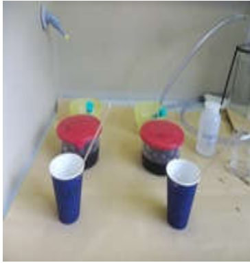
Slika 23. a. priprava smole i b. nanošenje kapljica smole na vlaknati supstrat
