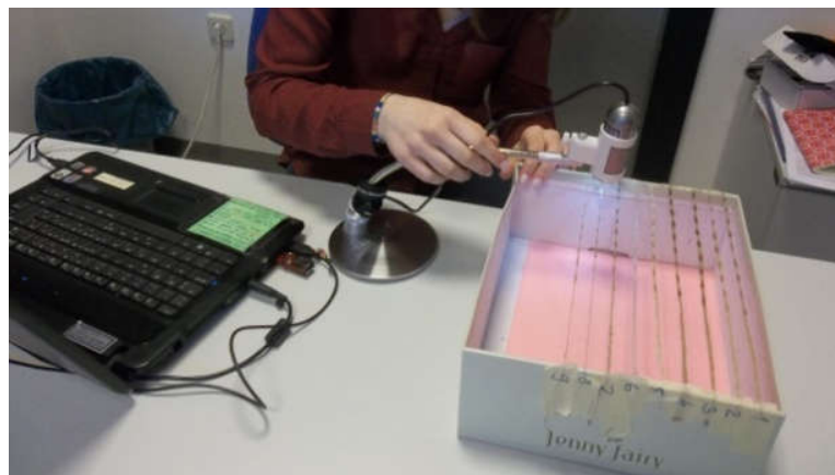
Slika 24. Fotografiranje prijenosnim USB optičkim mikroskopom – Dino-Lite
