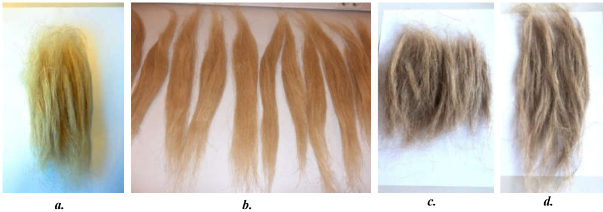
Slika 15. Snopići vlakana lana : a. predivi lan – kraća vlakna, b. predivi lan – dulja vlakna, c. sjemenski lan – kraća vlakna, d. sjemenski lan – dulja vlakna
