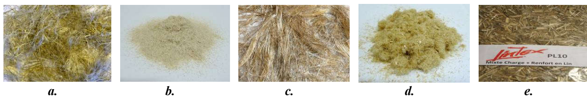
Slika 8. Kratka vlakna: a. Fibra © FRD - Fibres Recherche Développement, 100% lan ili konoplja, dostupne duljine od 1 do 150 mm, b. GREEN © FRD - Recherche Développement, 100% lan ili konoplja, dostupne duljine od 150 do 200 mm, c. NATHERM © FRD - Fibres Recherche Développement, 100% lan ili konoplja, dostupne duljine od 40 do 120 mm, d. Fibra ©, FRD - Fibres Recherche Développement, 100% lan ili konoplja i e. LINTEX ©, Groupe Dehondt, 100% lan (mješavina kratkih vlakana i drvenastog ostatka) [12]
