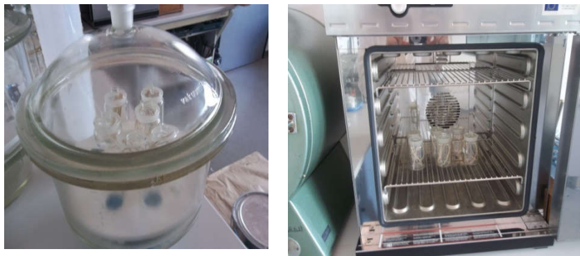
a. b. Slika 19. Prikaz: a. kondicioniranje uzoraka i b. sušenje
