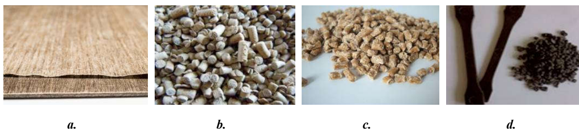
Slika 10. Netkano istosmjerno ojačano predimpregnirano ojačalo: a. PROCOTEX, UD laneni prepreg, matrica: TP i TS; Polimerni granulati ojačani kratkim vlaknima: b. LINCORE CP ©, GroupeDepestele, lan, matrica: PVC (polivinilklorid), PP (polipropilen), PLA (poliaktidna kiselina), ABS (acrylonitrilbutadienstiren); c. AFT PLASTURGIE, konoplja, matrica: ABS (acrylonitrilbutadienstiren), PVC (polivinil-klorid), PE (polietilen), PP (polipropilen); d. ECOTECHNILIN, lan, matrica: PPC (polipropilen karbonat) [12]
