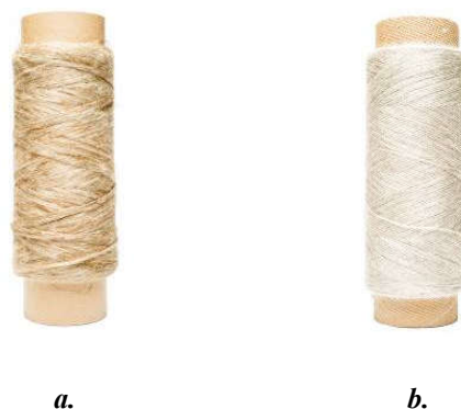
Slika 11. Roving pređa: a. NATTEX ROVING©, Dehondtgroup, 100% lan bez uvoja; b. Roving pređa male uvojitosti, Safilin, 100% lan [12]
