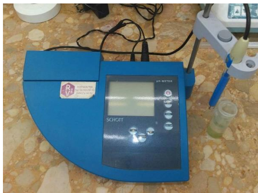
Sl. 12 pH metar CG 842, Scott, s elektrodom Blue Line 14 pH Geräte GmbH, Njemačka
