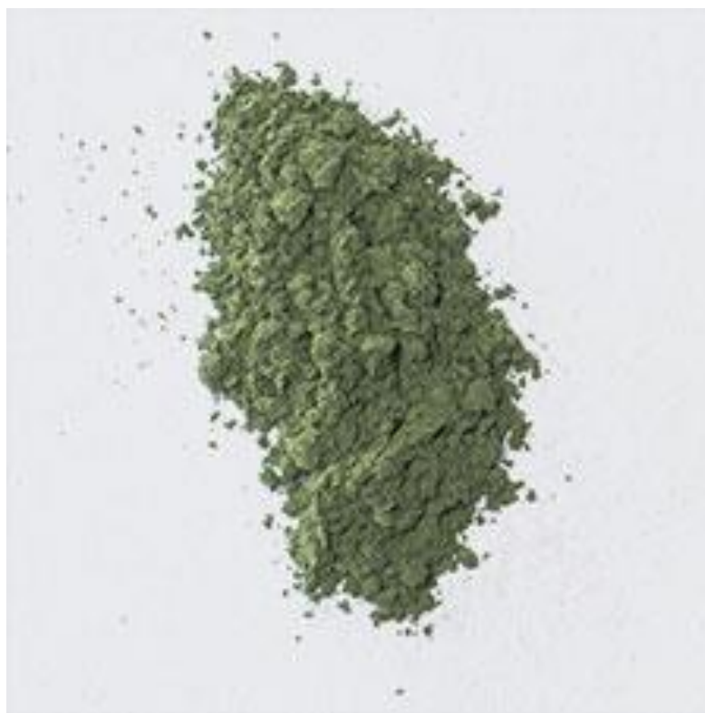
Sl. 5: Željezov pigment iz reda alumo-silikata; K[(Al, Fe^{III}), (Fe^{II}, Mg)](AlSi_3, Si_4) O_{10}(OH)_2 ; „Zemaljski zelena“ [26]
