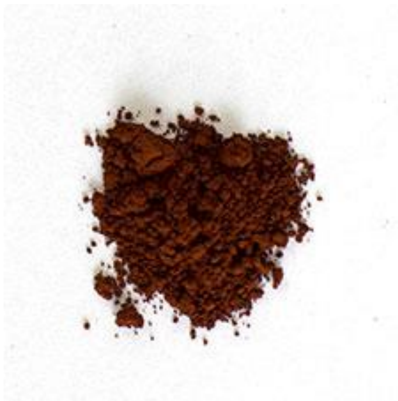
Sl.14: Hidratizirani željezov(III) oksid hidroksid; \text{FeO}(\text{OH}) \cdot n\text{H}_2\text{O} ; „Umbre“ [86]
