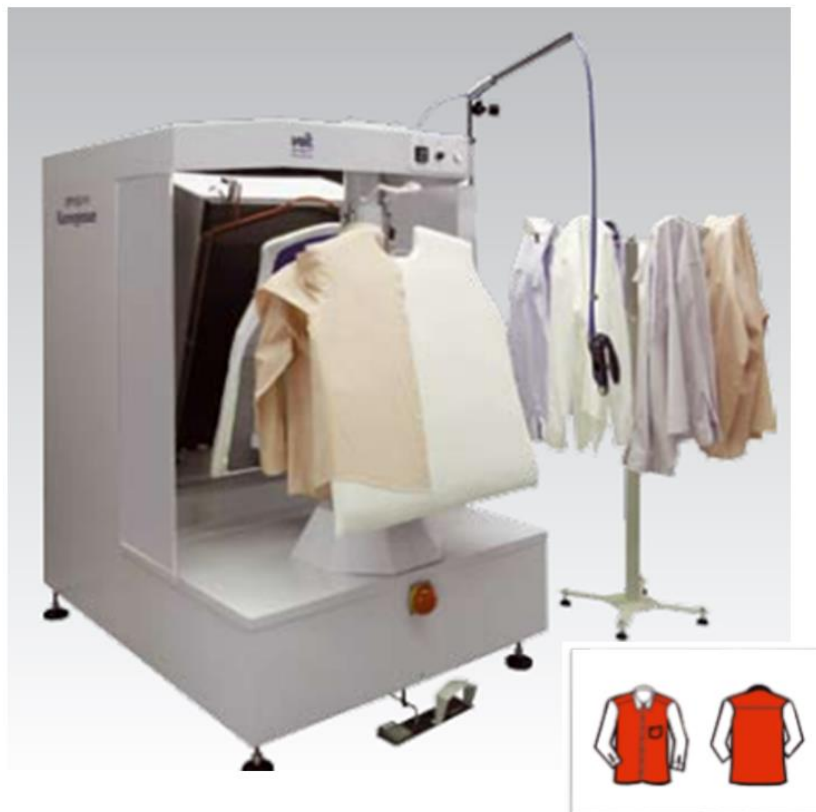
Sl. 22 Stroj za glačanje prednjih i stražnje strane muške košulje oznake VetroStar tt. Veit [17]
