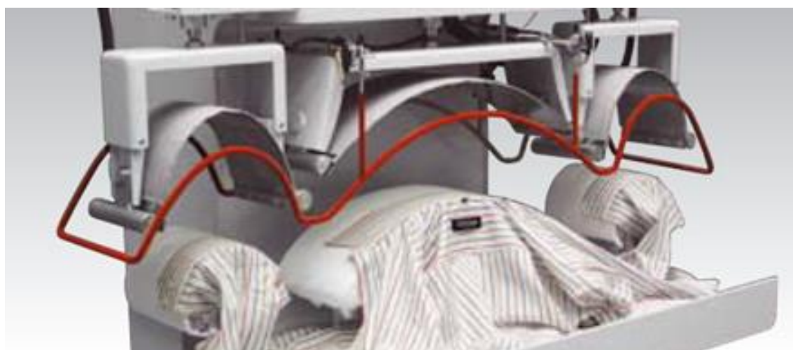
Sl. 18 Istovremeno završno glačanje ovratnika i orukvica [17]
