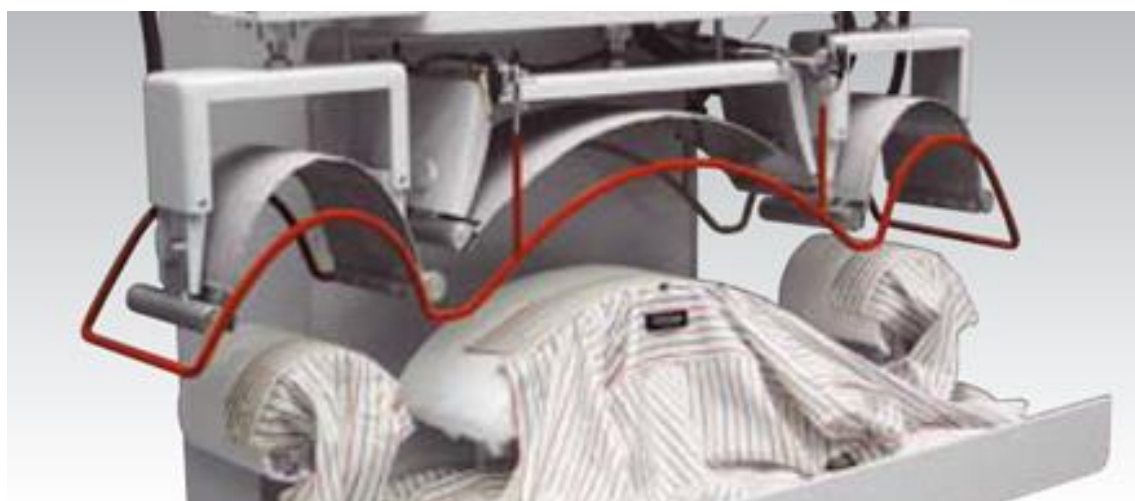
Sl. 18 Istovremeno završno glačanje ovratnika i orukvica [17]
