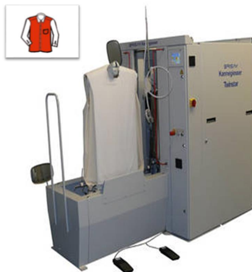
Sl. 26 Stroj za tunelno glačanje tijela košulje oznake HP-V2 [17]
