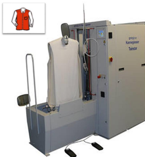
Sl. 26 Stroj za tunelno glačanje tijela košulje oznake HP-V2 [17]
