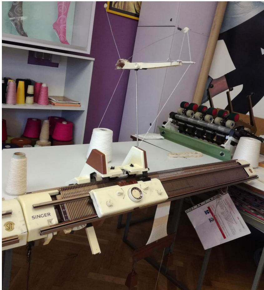
Slika 8 – ravnopletači, dvoiglenični stroj (Singer)
