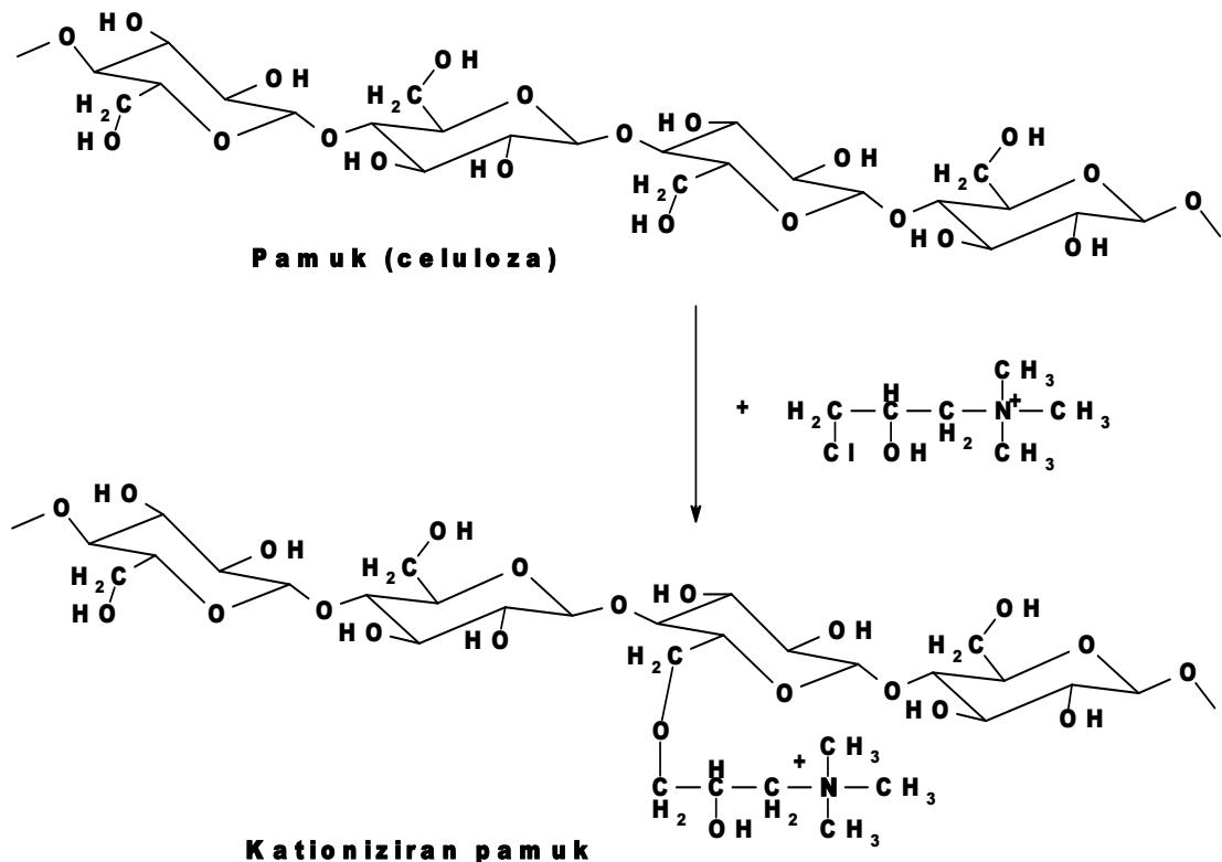
**Slika 7 - Kationiziranje pamuka kratkolančanim kationskim spojem 3-kloro-2-hidroksipropil trimetil amonijevim kloridom (CHPTAC) [19]**
