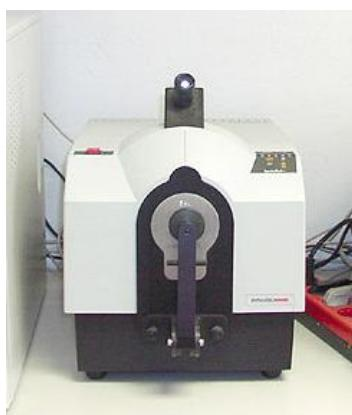
**Slika 11 - Remisijski spektrofotometar Spectraflash SF 600 PLUS-CT**
