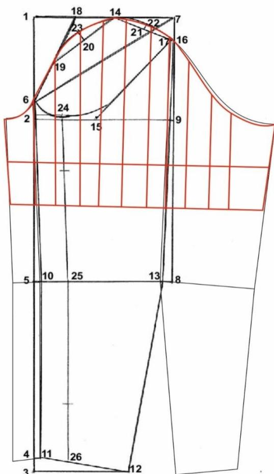
Slika 21. Temeljni konstrukcijski krov rukava sa označenim dijelovima rezanja.
