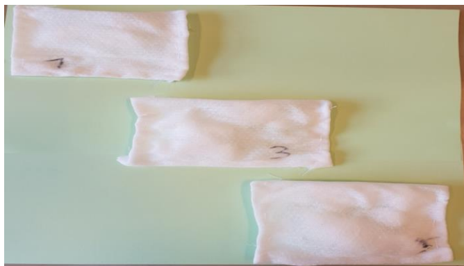
Slika 7 Uzorci od 1 g, 3 g i 5 g sašiveni u violeta maramicama
