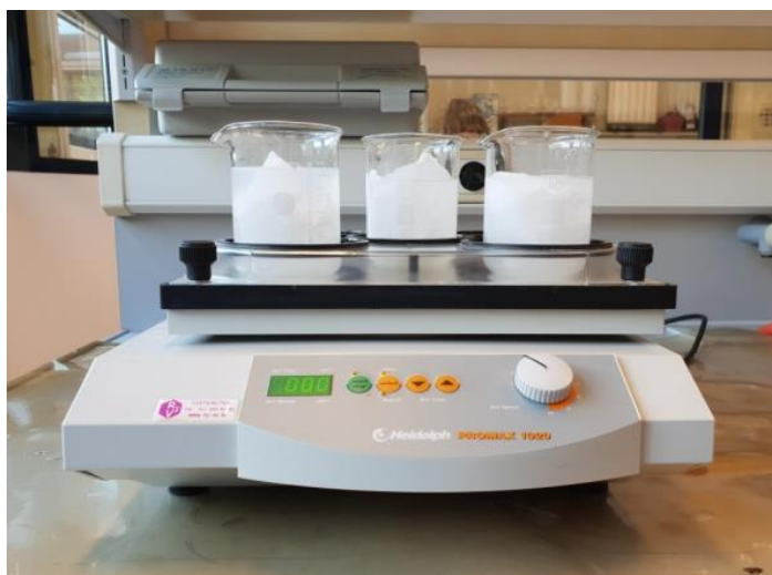
Slika 15 Uzorci tijekom ispitivanja na mućkalici
