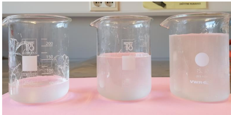
Slika 13 Maksimalni volumen kojeg SAP od 1 g, 3 g i 5 g mogu upiti
