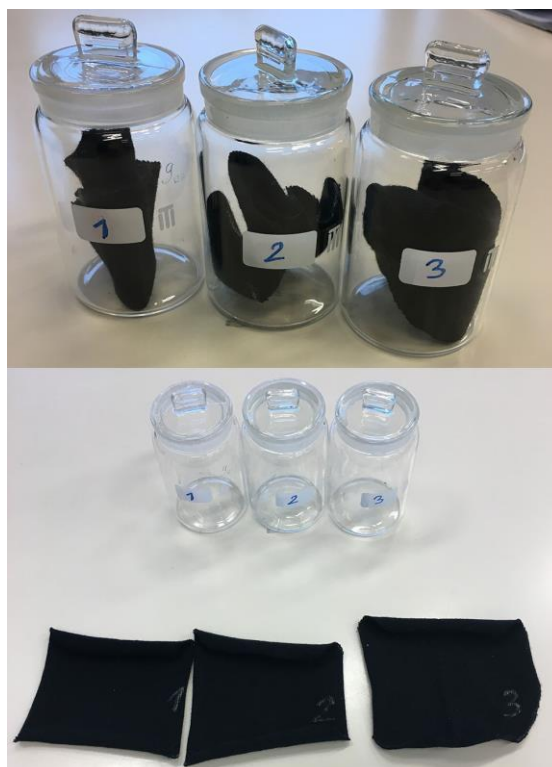
Slika 10. Uzorci pletiva za ispitivanje plošne mase
