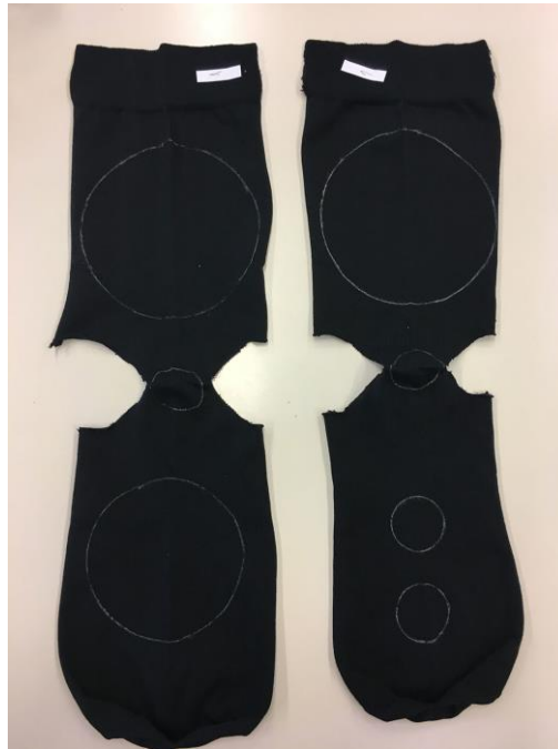
Slika 7. Uzorkovanje čarapa za namjenu ispitivanja sklonosti pilingu, otpornosti na habanje i utvrđivanje plošne mase
