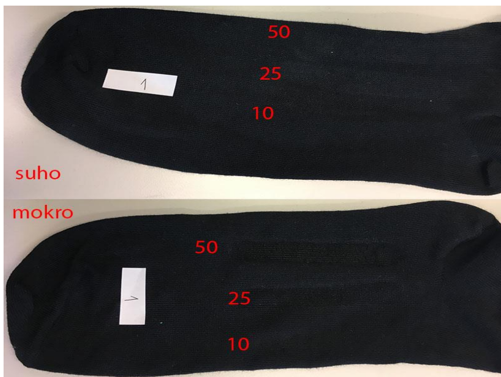
Slika 24. Prikaz tragova suhog i mokrog trljanja na uzorku 1 uz pripadajuće oznake broja ponavljanja
