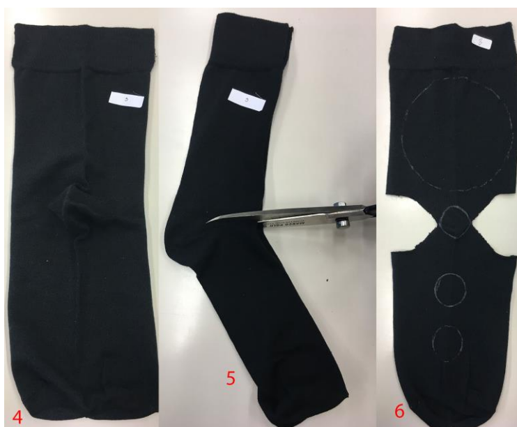
Slika 9. Priprema čarape za izuzimanje uzoraka po koracima (1 dio): 4-rastvaranje čarape (provjera proreza do prstiju), 5-prorezivanje čarape između tijela i stopala čarape do pete ostavljajući minimalno 40 mm pete u raširenom stanju za izuzimanje uzorka na otpornost habanja (iznos 38 mm)
