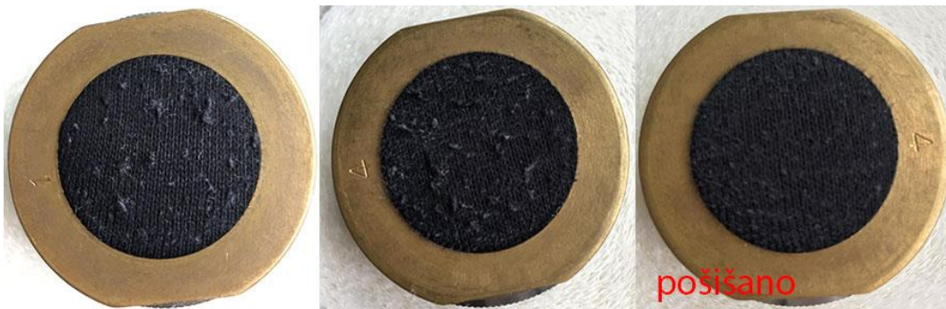
Slika 31 Nakon 20000 habajućih ciklusa, slika lijevo je uzorak izuzet iz pete čarape, u sredini je uzorak izuzet iz tabana, desno uzorak tabana pošišan – vidljiva mjesta stanjenja
