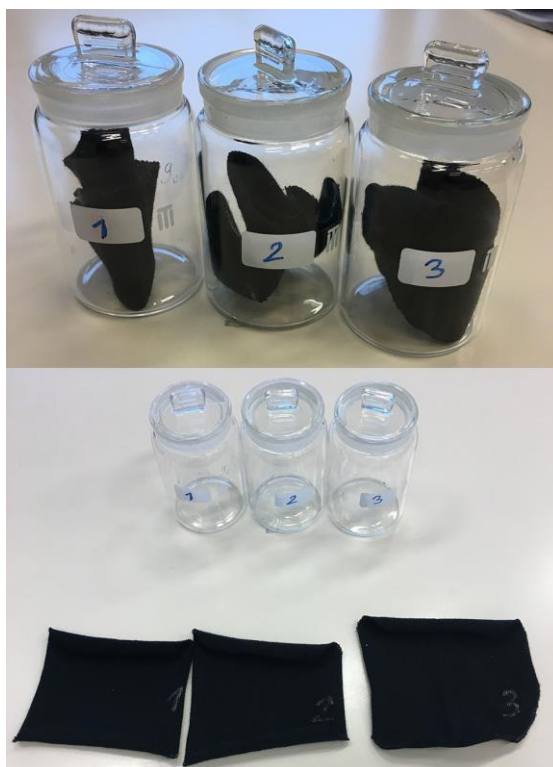
Slika 10. Uzorci pletiva za ispitivanje plošne mase
