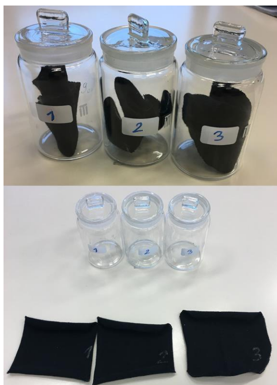
Slika 10. Uzorci pletiva za ispitivanje plošne mase
