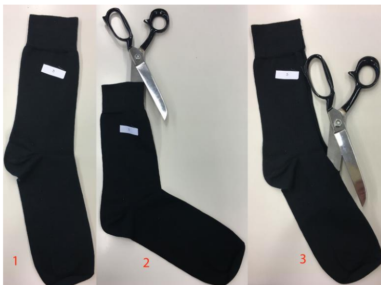
Slika 8. Priprema čarape za izuzimanje uzoraka po koracima (1 dio): 1-vodoravno položena izglučana čarapa, 2-rezanje čarape po prednjoj sredini čarape, 3-prorezivanje čarape do prstiju (šava)
