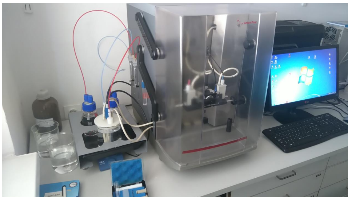
Slika 12. SurPASS, uređaj za mjerenje zeta potencijala
