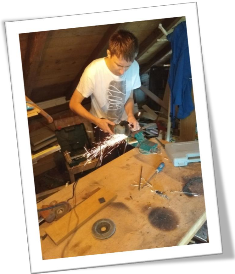
Slika 33. Priprema i obrada metalnih žica prije postupka zavarivanja
