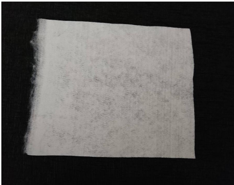
Slika 11: Netkani tekstil od poliesterskih vlakana učvršćen iglanjem [15]
