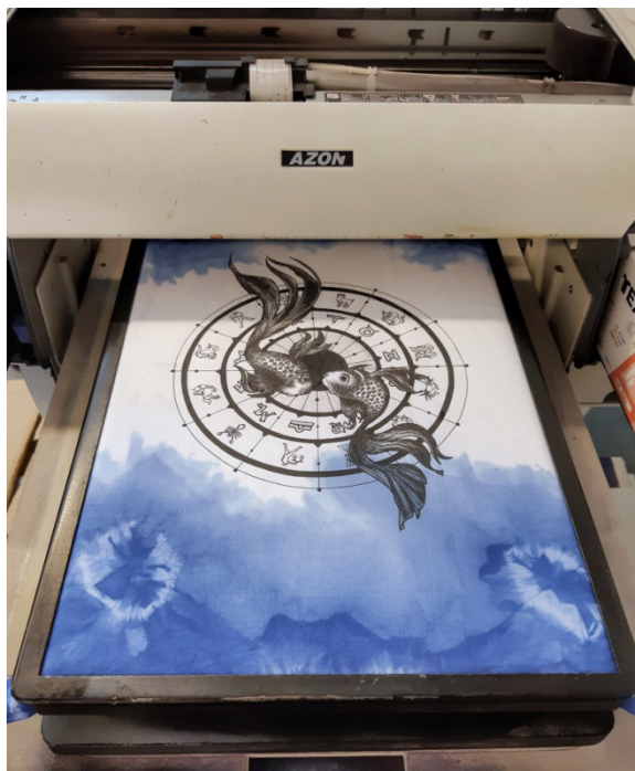
Slika 43: Otisnut likovni predložak, Inkjet Azon TexPro Series2 printer
