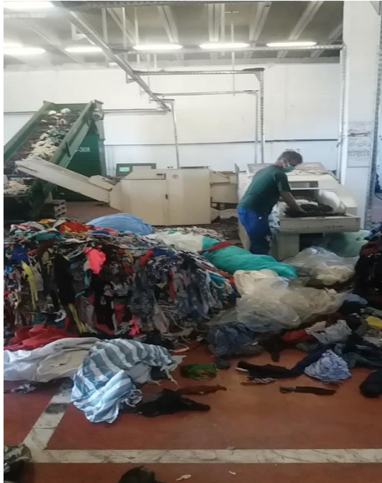
Slika 2. Odvajanje i usitnjavanje materijala
