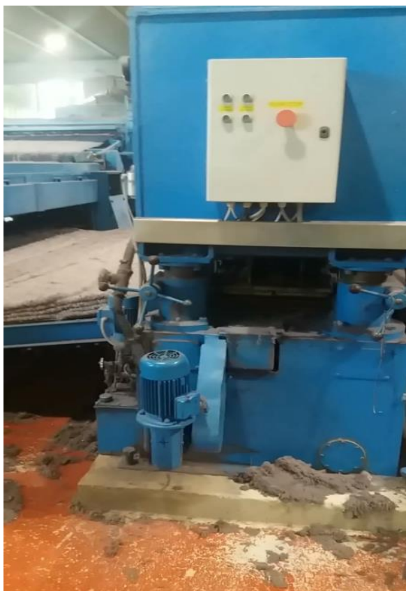
Slika 3. Iglanje položenog runa sa faze polaganja runa na križnom polagaču
