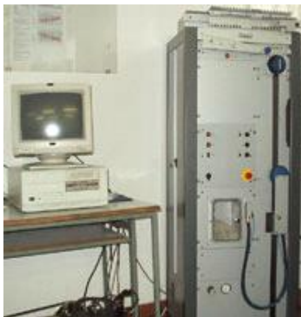
Slika 9. Dinamometar STATIMAT M- t.t. Textechno, Njemačka
