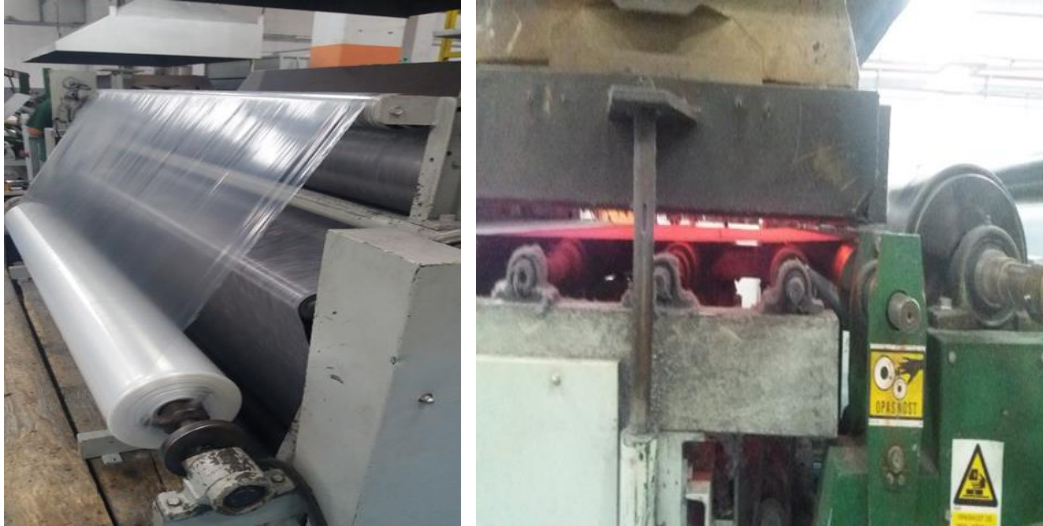
Slika 5. Spajanje LDPE folije i netkanog tekstila iz regenerata
