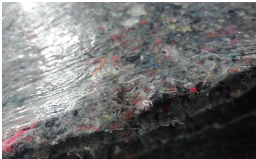
Slika 7. Netkani tekstil od regenerata površinske mase 250 g m -2
