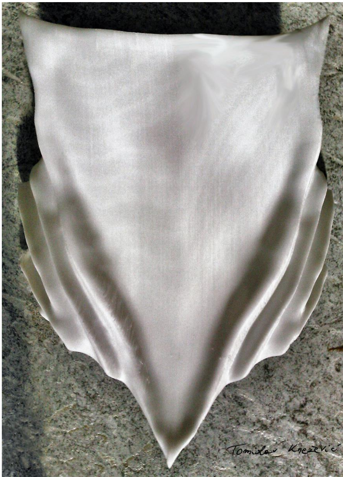
Vlastiti izvor, izrađeni prototip, 2017., 3D tisak pomoću ABS materijala, 34.5 cm x 29.5 cm x 2 mm.
