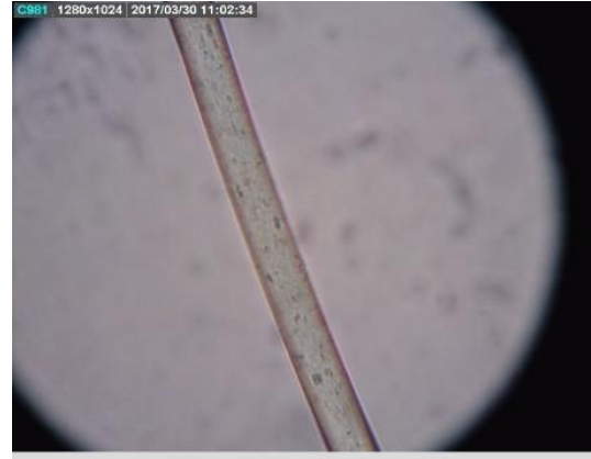
Slika 29. Mikroskopiranje vlakana u zagrijanom ClZnI
