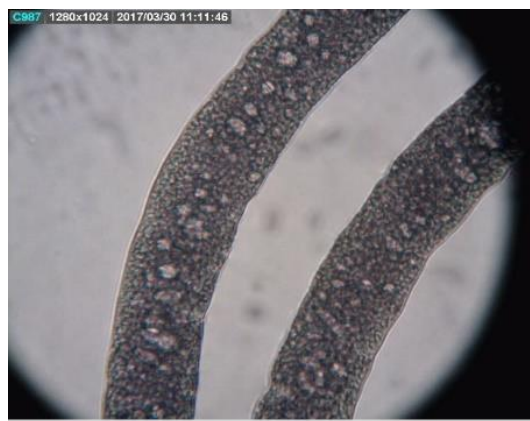
Slika 32. Mikroskopiranje vlakana u zagrijanom ClZnI
