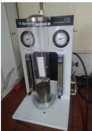
Slika 10. Uređaj za mjerenje graničnog indeksa kisika [29]
