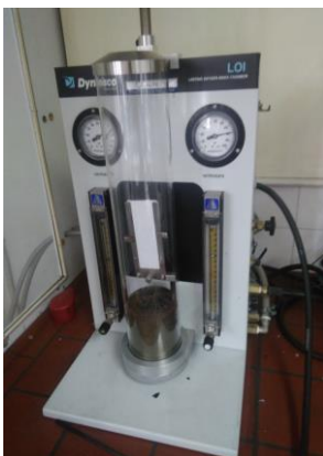
Slika 10. Uređaj za mjerenje graničnog indeksa kisika [29]
