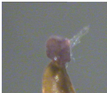
Sl. 20. Jedinični kristal kompleksa [\text{Co}(\text{acac})_2(\text{HL})_2] podvrgnut difrakcijskom pokusu
