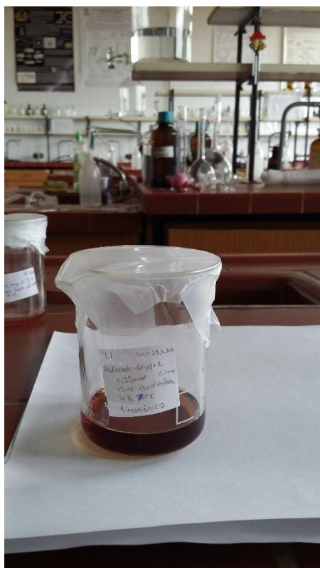
Sl.18. Matičnica nastala reakcijom \text{Co}(\text{acac})_2 \cdot 2\text{H}_2\text{O} i HL u molarnom omjeru 1:2 u etanolu
