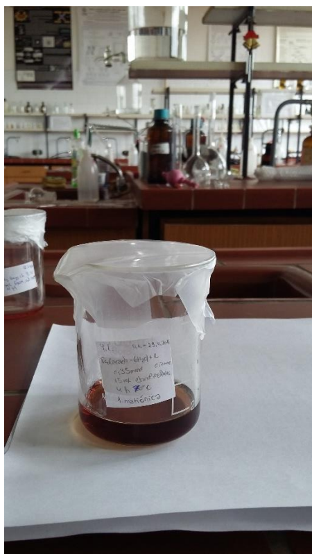
Sl.18. Matičnica nastala reakcijom \text{Co}(\text{acac})_2 \cdot 2\text{H}_2\text{O} i HL u molarnom omjeru 1:2 u etanolu
