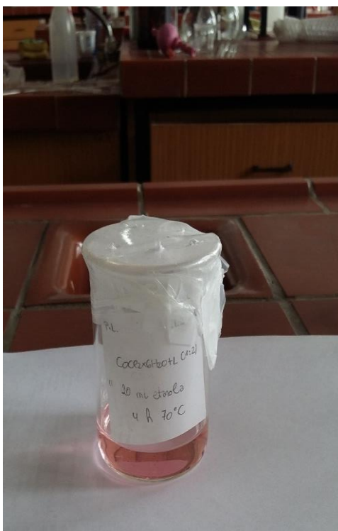
Sl.17. Matičnica nastala reakcijom \text{CoCl}_2 \cdot 6\text{H}_2\text{O} i HL u molarnom omjeru 1:2 u etanolu
