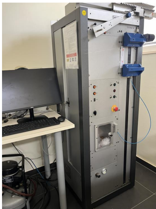
Slika 3.2.3.1 Dinamometar Statimat M njemačke tvrtke Textechno
