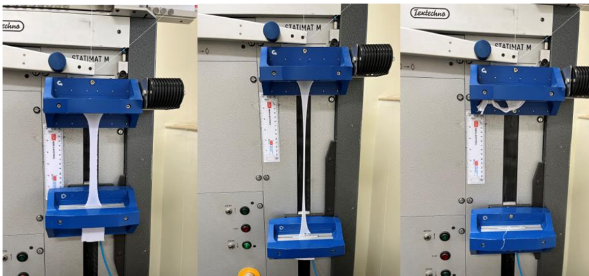
Slika 3.2.3.2 Tijek ispitivanja vlačnih svojstava pletiva
