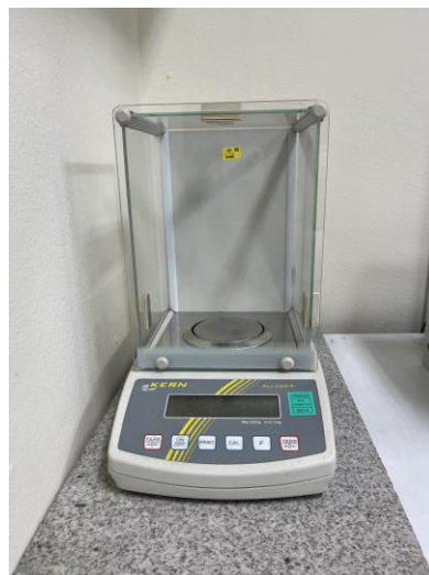
Slika 3.2.1. Ispitivanje plošne mase pletiva (kružni rezač i analitička vaga)
