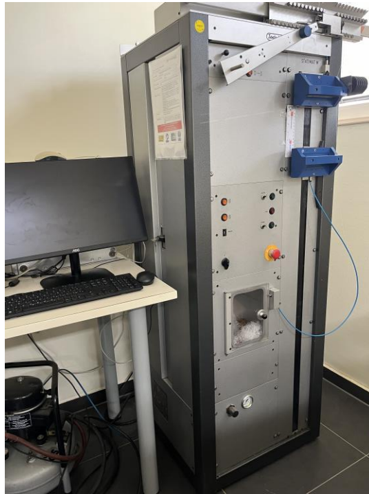
Slika 3.2.3.1 Dinamometar Statimat M njemačke tvrtke Textechno
