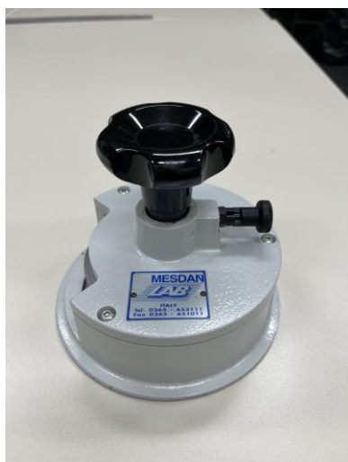
Slika 3.2.1. Ispitivanje plošne mase pletiva (kružni rezač i analitička vaga)
