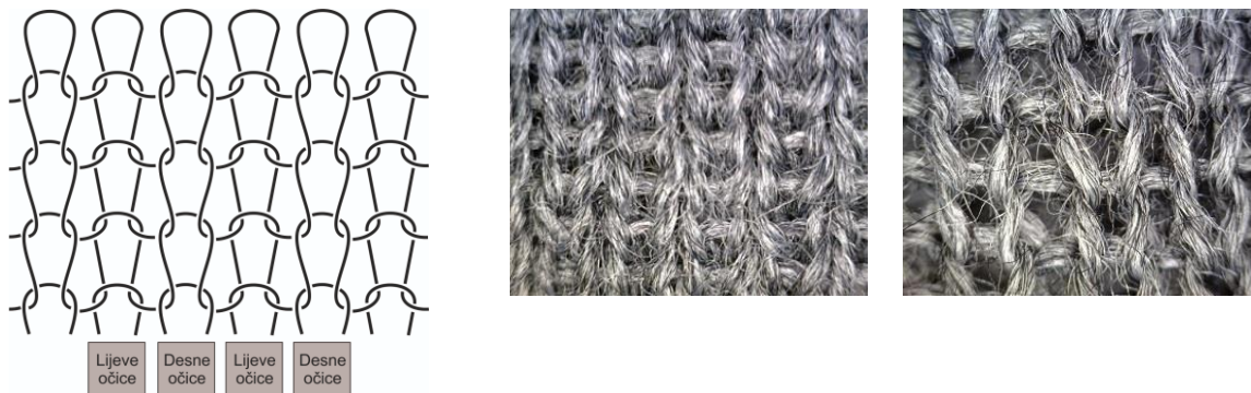
Slika 3.1.2 Struktura očica i izgled pletiva (D-D) [15]
