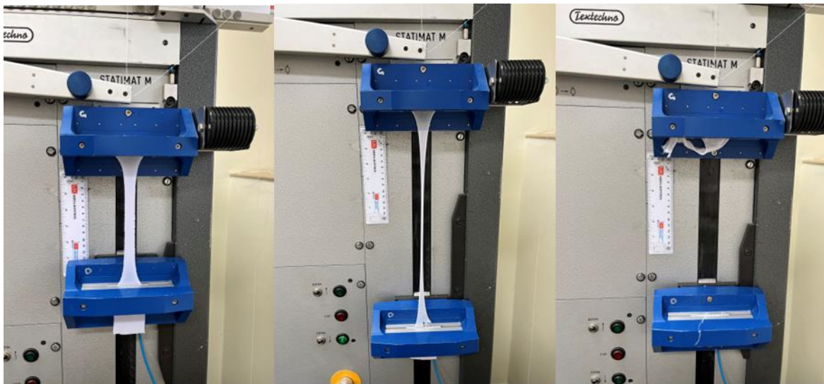
Slika 3.2.3.2 Tijek ispitivanja vlačnih svojstava pletiva
