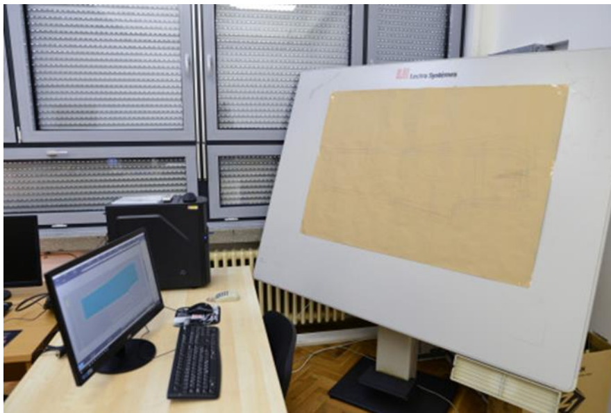
Slika 10: Prikaz unosa krojnih dijelova postupkom digitalizacije [34]
