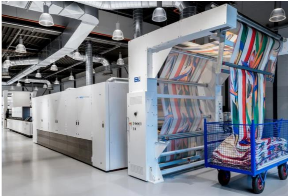
Slika 64. SPG Prints, primjer suvremenog stroja za digitalni tisak 102
