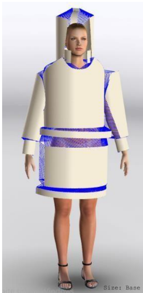
Sl. 38. Virtualno spajanje krojnih dijelova na 3D model
